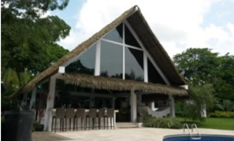
Su estructura es elaborada en Madera eucalipto descortezada, distancia entre columnas de 10m X 20m.
