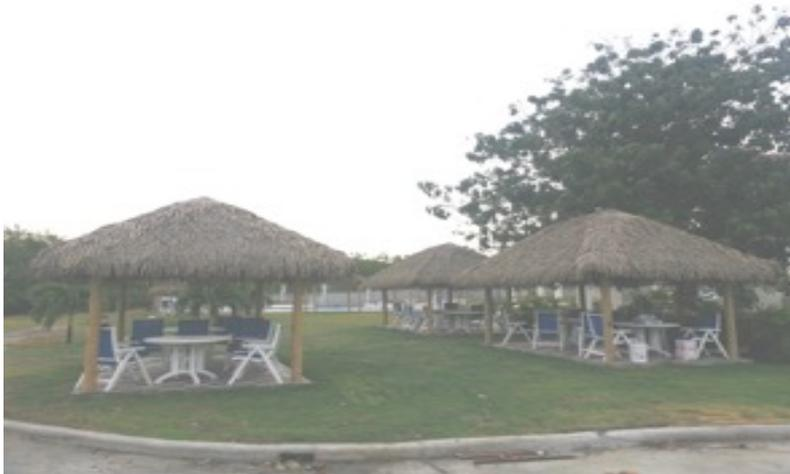
Su estructura es elaborada en Madera Aserrada, distancia entre columnas de 5m X 3m. Palmex referencia Aloha a 35°, Alero de 60cm perimetral.
