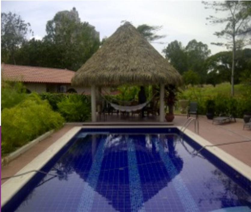
**Estructura elaborada en Madera Aserrada, distancia entre columnas de 3 mts. Palmex referencia ALOHA a 35°, Alero de 60 cm perimetral.**
